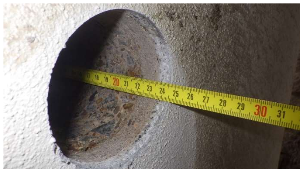
Foto 6.5.2 Měření celkové hloubky provedeného jádrového vývrtu Ø75 mm s označením V-05 odebraného z boční stěny 2. sloupu pilíře P3 zprava
