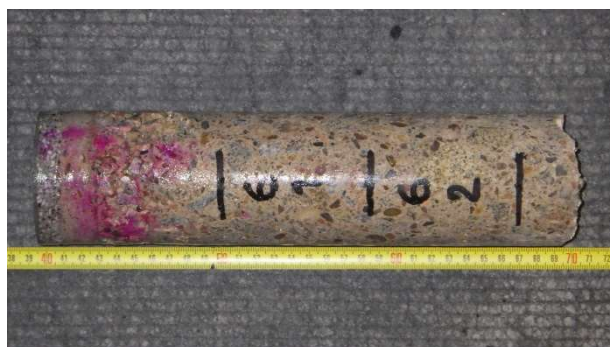
Foto 6.6.4 Laboratorní foto vzorku s označením V-06 včetně provedeného testu hloubky karbonatace a s vyznačenou polohou zkušebních těles
