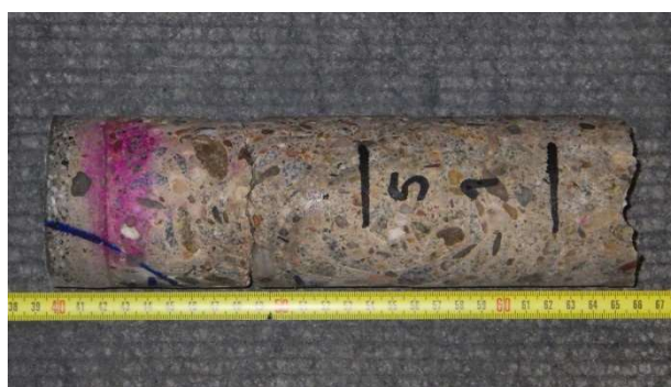
Foto 6.5.4 Laboratorní foto vzorku s označením V-05 včetně provedeného testu hloubky karbonatace a s vyznačenou polohou zkušebních těles
