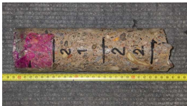
Foto 6.2.4 Laboratorní foto vzorku s označením V-02 včetně provedeného testu hloubky karbonatace a s vyznačenou polohou zkušebních těles
